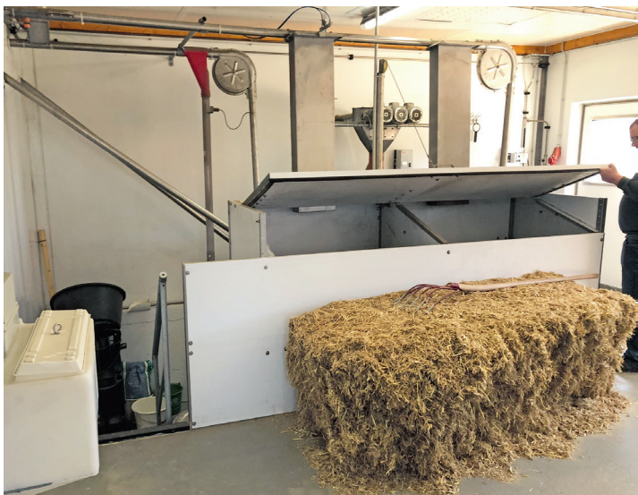
Neben Stroh als Rund- oder Quaderballen können auch weitere Materialien wie zum Beispiel Luzerne oder Pellets verarbeitet werden. Über ein Fördersystem wird das Material in den Stall gebracht (linkes Bild). In Rinderställen wird von oben über ein Rohrsystem eingestreut.
