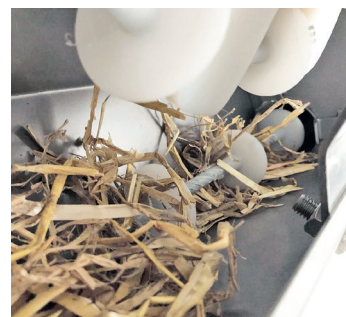
Langstroh bis zu einer Länge von 8 cm kann mit dem Förderseil transportiert werden.
